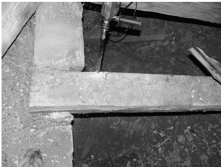
2 iliustracija. Perdangos sija virš presbiterijos, datuota 1572 m. Nuotraukoje matyti medienos mėginių paėmimo gražtas. Adomo Vito nuotrauka, 2018
